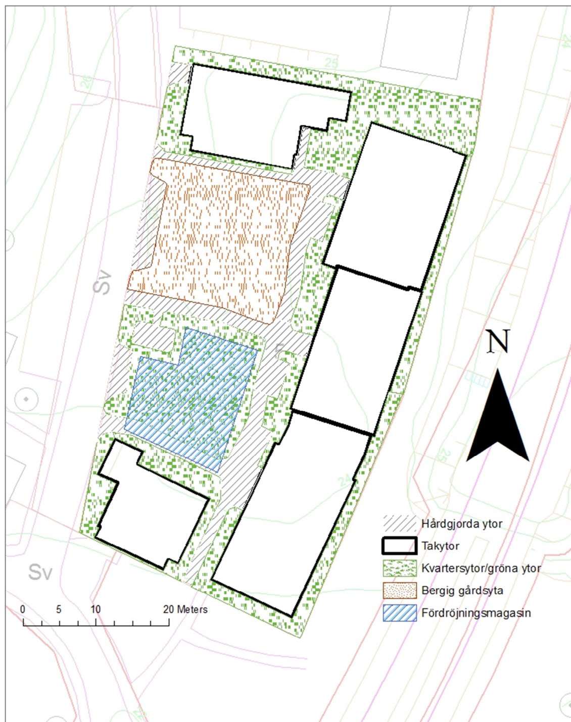
Figur 4-1. Principskiss över dagvattenhanteringen inom Gamlebo 5. Fördröjningsmagasinet placeras inom den blåstreckade ytan i den södra delen av fastigheten, norr om huskropp A. Den blåstreckade ytan är betydligt större än nödvändig yta för fördröjningsmagasinet.
