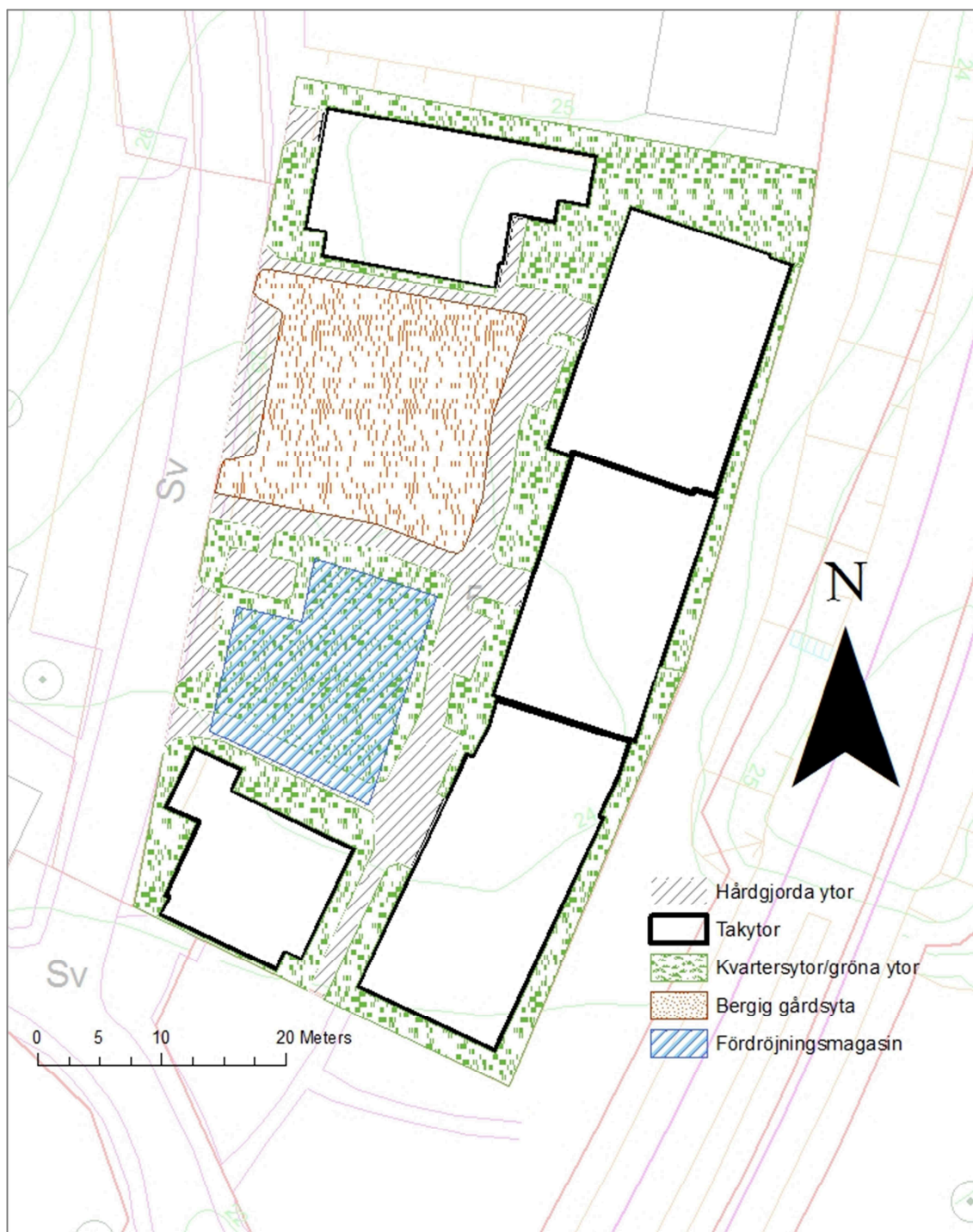
Figur 4-1. Principskiss över dagvattenhanteringen inom Gamlebo 5. Födröjningsmagasinet placeras inom den blåstreckade ytan i den södra delen av fastigheten, norr om huskropp A.
