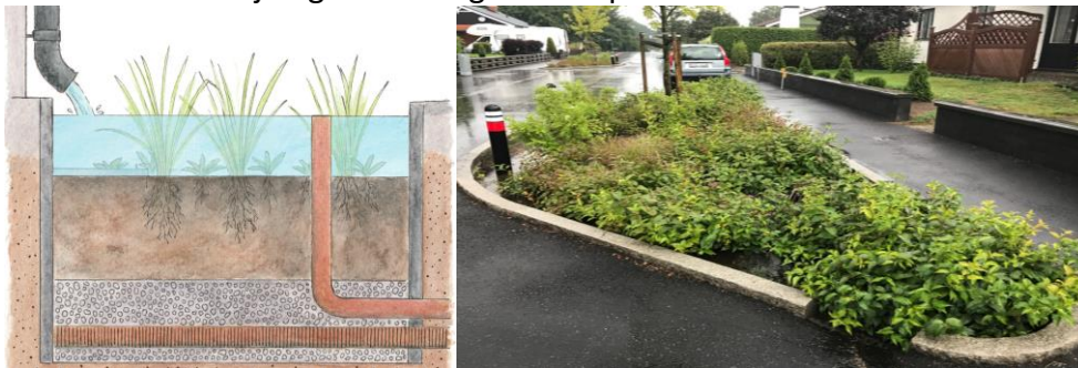
Figur 17. Principskiss som visar en nedstänkt växtbädd i anslutning till stuprör med vattenutkastare till vänster och växtbädd med kantsläpp till höger (VA-Guiden, u.å; Blomqvist, 2021 9 )
