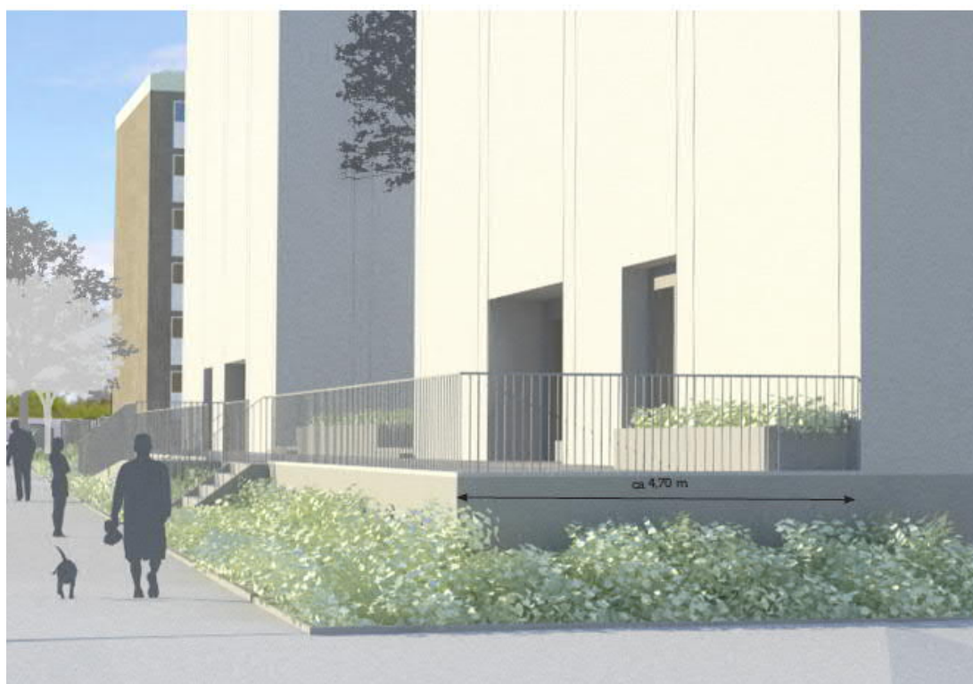
Figur 7. Bilden visar gröna ytor på förgårdsmarken som kan användas för att omhänderta dagvatten (växtbäddar) från förgårdsmarken mot Ölmevägen.
