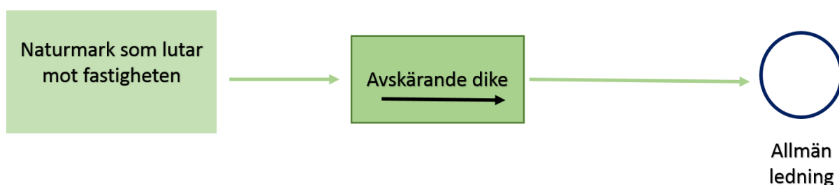
Figur 27 Principskiss över föreslagna dagvattenlösningar vid skyfall.
