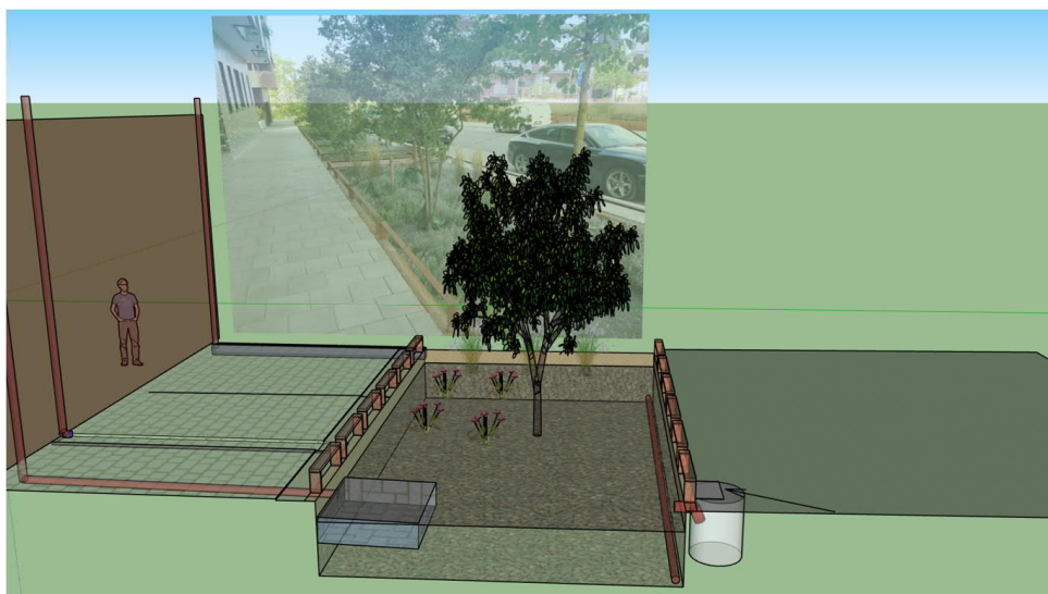
Figur 37. Illustration av tre möjliga stuprörsförbindelser som möjliggör takavvattning till växtbäddar. Närmast: Ledning till bevattningslåda (eftersom utloppet blir så pass lågt). Mitten: fasad platta. Kombinerar alltid med uppvärmt stuprör och minst 2% lutning för att förhindra svallis. Bortre: Stuprör med utlopp i linjeavvattningsränna.
