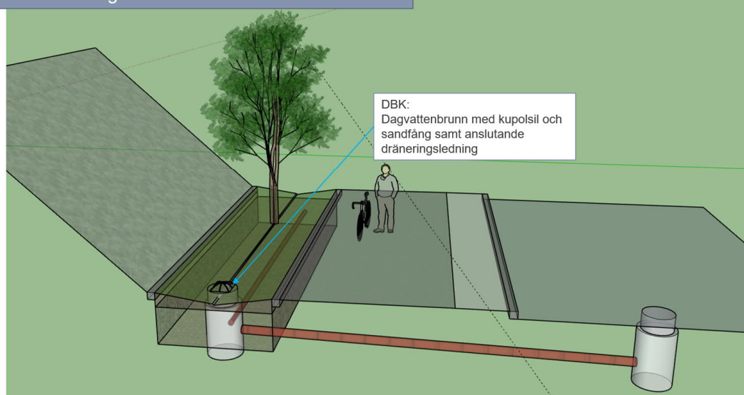
Figur 29. Dräneringsstråk och reningsstråk längs vägar eller GC-banor enligt stadens typsektion THVB025.
