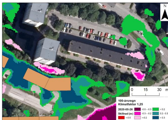
Figur 20. Skillnad i maximala vattennivåer mellan nuläget och ett framtida läge vid ett 100-årsregn med klimatfaktor 1,25. Rosa områden visar på ökade vattennivåer jämfört med nuläget.
