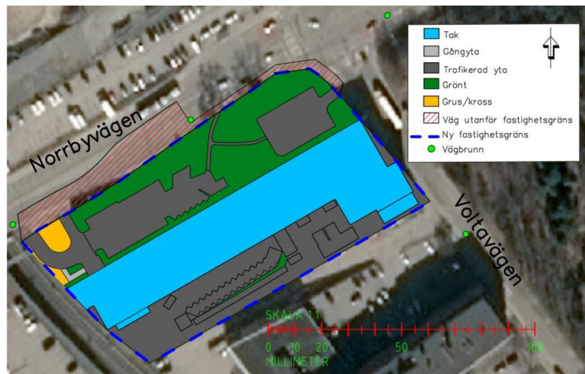
Figur 2. Ytor som ingår i avrinningsberäkningen. Röd streckad yta är del av vägbana som bedöms tillföra dagvatten till fastigheten. Observera liten förskjutning i flygfoto.
