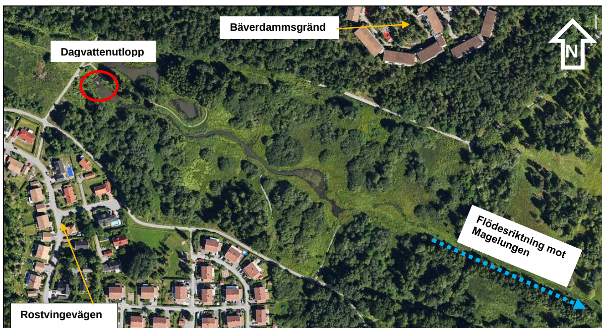
Figur 3. Kräppladikets övre delar med dammar vid dagvattenledningens inlopp samt meandrande sträckning (flygfoto från Eniro.se).
