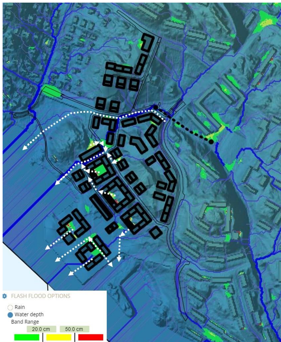
Figur 15 Maximalt vattendjup och flödesvägar vid ett 56 mm regn vid analys med en kulvert för riskområde nordöst om planområdet. Planerade bebyggelse markeras med fet svart linje, planerade vägar med svart. En åtgärd (kulvert) för område i nordväst markeras med en streckad svart linje. Förslag för avledningsväg för skyfallsvatten markeras med vita pilar. Kartan skapades med Scalgo Live (2019).
