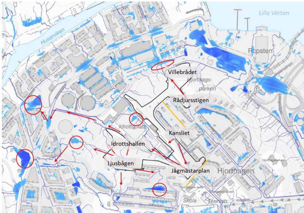
Figur 17. Flödesvägar (röda pilar), lågpunkter (röda ringar) och vattendelare (orange linjer) vid 56 mm regn. Plangräns i svart.
