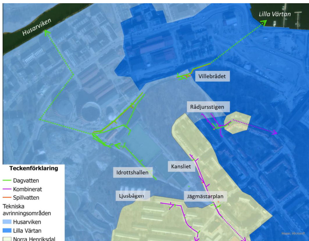
Figur 14. Tekniska avrinningsområden (Stockholms stad, Öppna data, 2023) samt befintligt dag- och spillvattenledningar (utdrag från ledningsunderlag 2022-09-30) i utredningsområdet.
