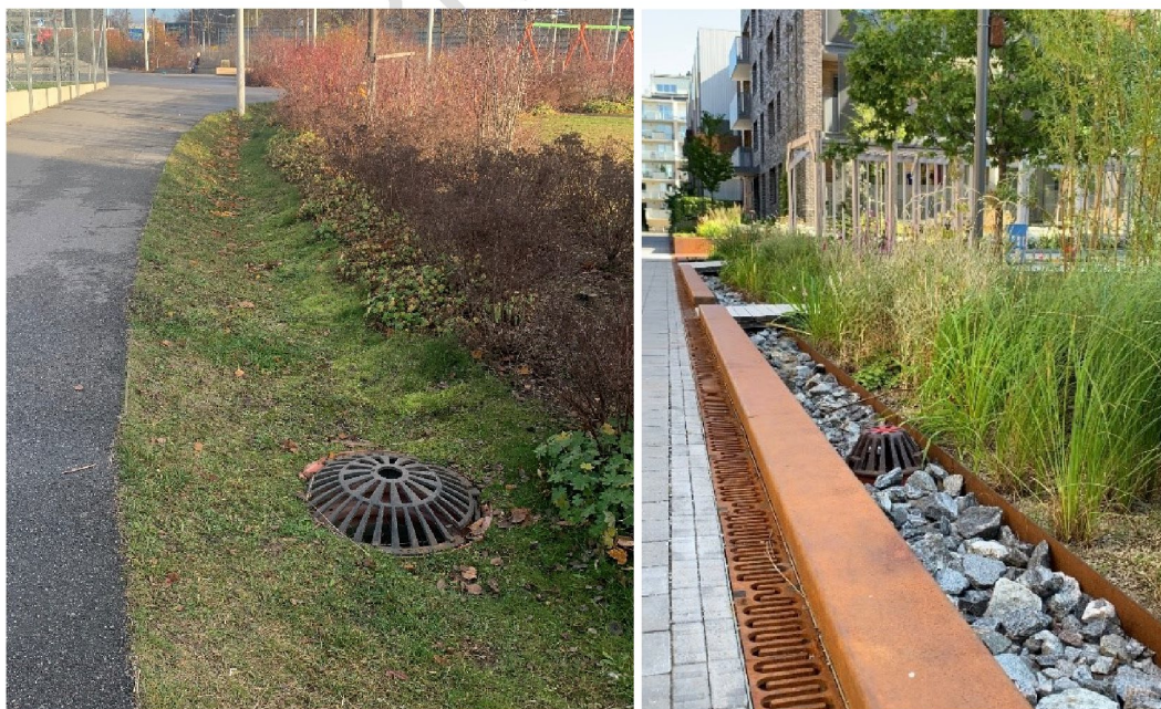
Figur 12. Exempel på gräsbeklätt infiltrationsstråk (t v) samt infiltrationsstråk med makadam (t h). Foto: Bjerking AB.
