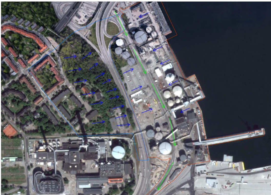
Figur 15 – Ytliga avvattningsvägar markerade på ett flygfoto. Blå pil markerar yttlig avrinning och grön pil ledningsbunden avrinning. Planområdet markeras med röd linje medan blå linje indikerar tillkommande avrinningsområde vid skyfall.
