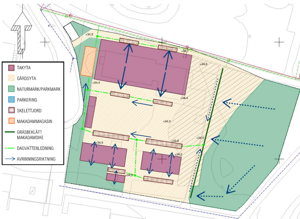
Figur 5-3. Förslag på avvattningsplan för planområdet, inklusive föreslagna dagvattenlösningar. Redovisas även i Bilaga 1 – Avvattningsplan.
