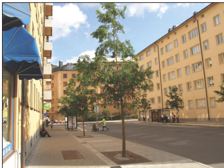
Figur 21. Exempel på trädrad i skelettjord. Dagvatten avleds till skelettjord via dagvattenbrunnar/luftningsbrunnar
