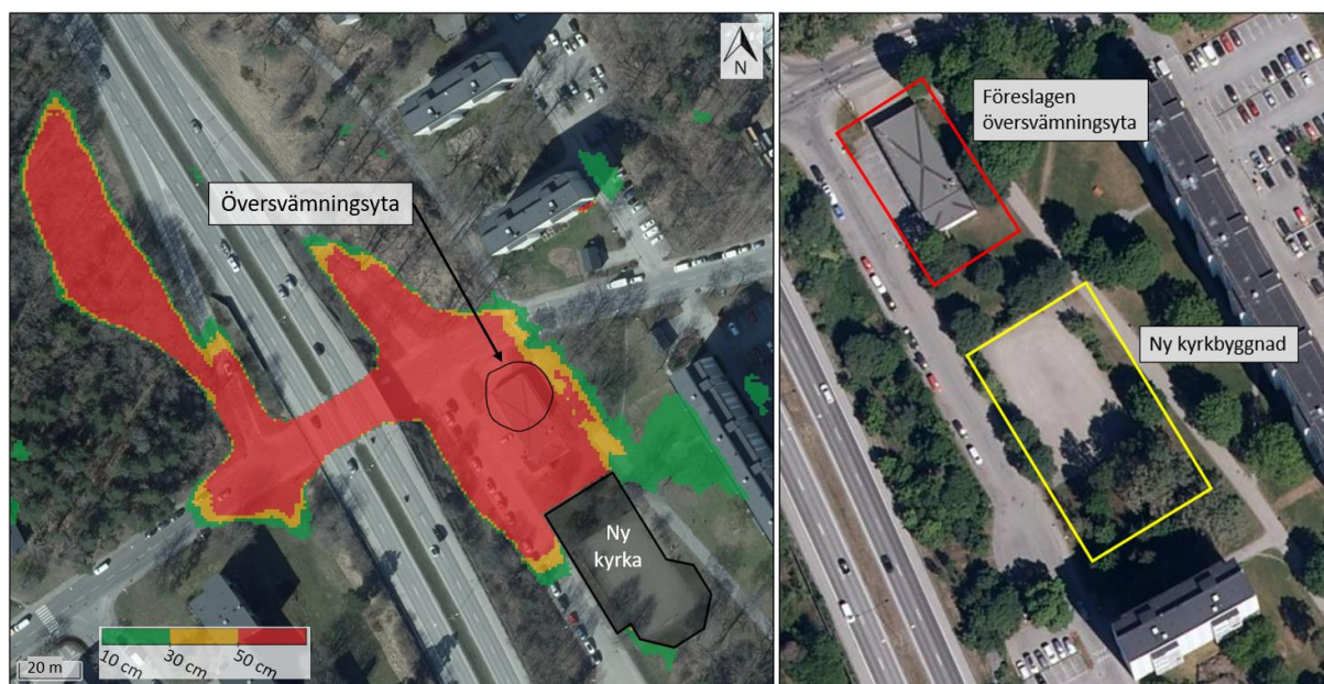
Figur 14. T.v. Vattendjup i lågpunkt 1 vid 50 mm regn med framtida bebyggelse, samt läge för föreslagen översvämningsyta. Effekten av översvämningsytan medräknas inte i analysen (Kartkälla: SCALGO Live, 2022). T.h. Föreslagen översvämningsyta vid Etiopiska kyrkan samt ytan inom vilken den nya kyrkbyggnaden föreslås uppföras (Kartkälla: Eniro, 2020)
