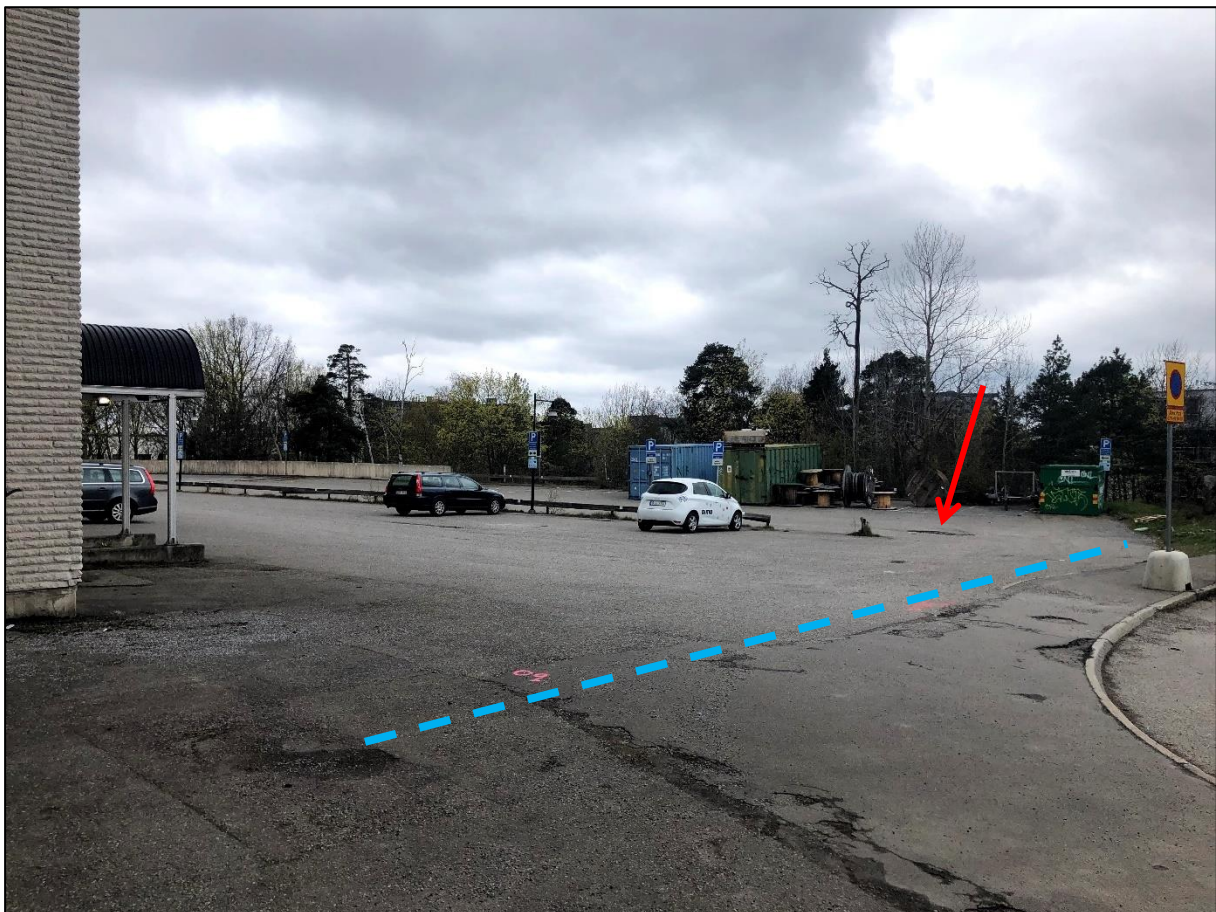
Foto 1. Vattendelare mellan vändplanen och parkeringen i Enigheten 25 markerad med blå streckad linje. Lågpunkten ungefärligt markerad med en röd pil.
