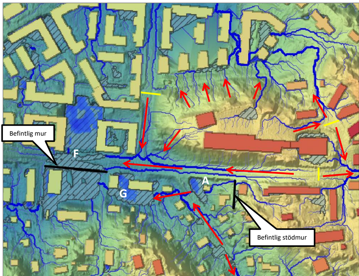
Figur 3-9. Ytavrinning och områden med ökad översvämningsrisk i samband med att 50 mm nederbörd ansätts på all terräng. Röda pilar visar avrinningsriktning och gula linjer visar ungefärligt befintliga vattendelare på gaturummen.
