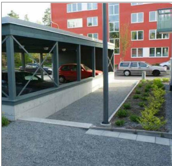
Figur 6-8. Exempel på genomsläpplig beläggning i form av grus (Uppsala Vatten, 2014).
