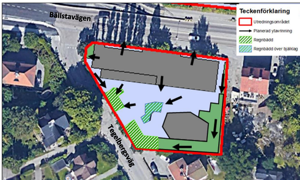
Figur 6-12. Förslag på hållbar dagvattenhantering inom södra delen av utredningsområdet.
