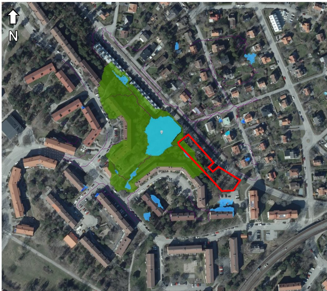
Figur 15. Tillrinningsområde i grönt till delvis höjd lågpunkt (1,2 m) vid 68 mm regn. Ljusblått indikerar att kapacitet i lågpunkten finns kvar.
