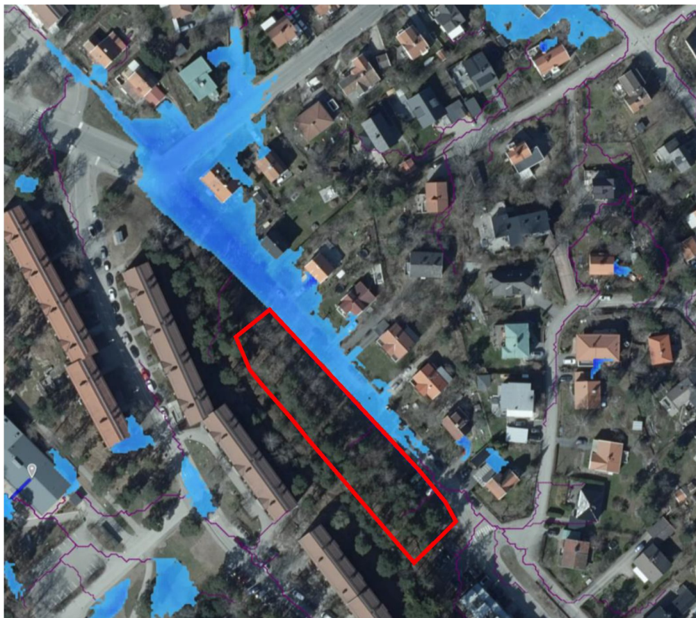
Figur 17. Norra planområdet avvattnas till lågpunkt i Sägverksgatan. Bilden visar situationen vid 68 mm regn.
