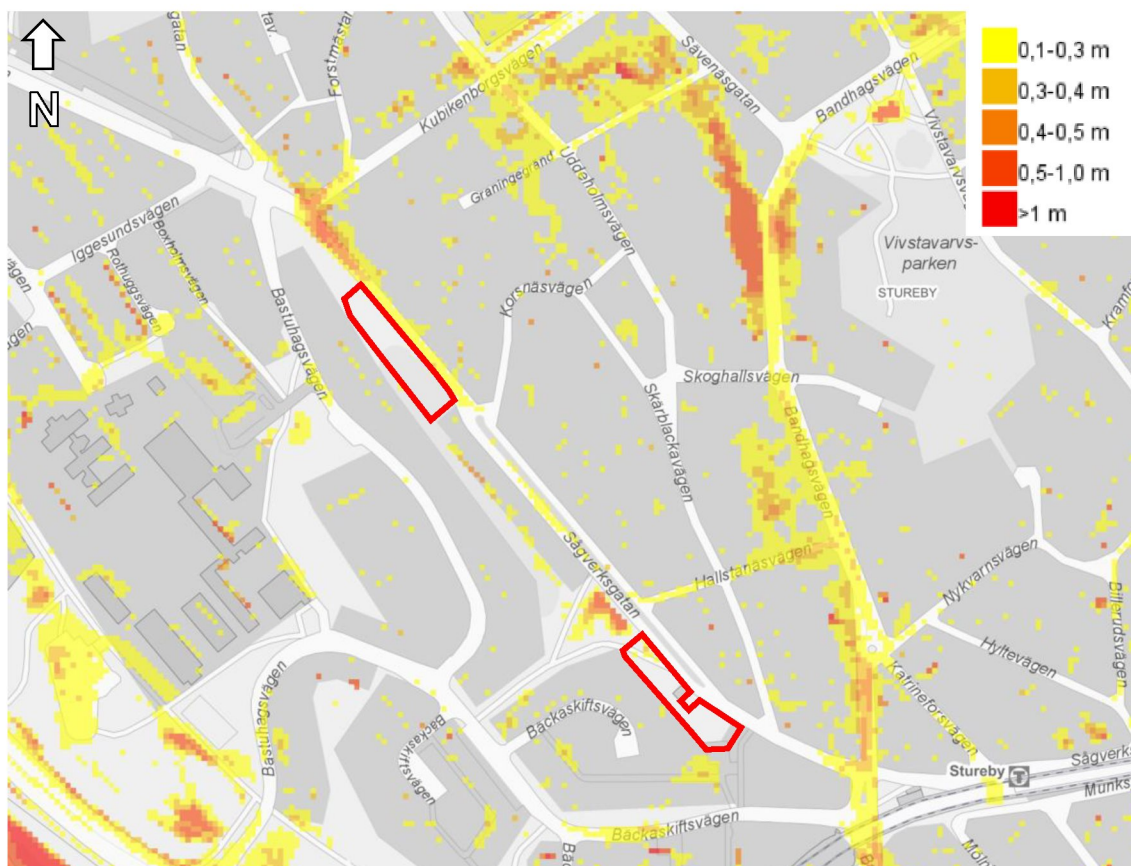
Figur 11. Skyfallsmodellering för 100-årsregn där maximalt vattendjup under simuleringstiden framgår. Det norra och södra planområdena är markerade med röd streckad linje. (miljodataportalen.stockholm.se)
