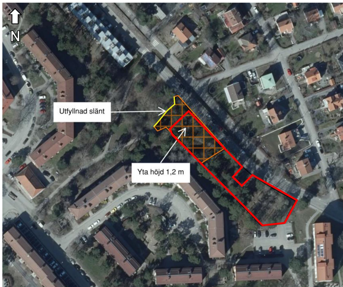
Figur 14. Modellering av höjning av del av lågpunkt vid södra planområdet. Orange skraffering markerar yta som höjts 1,2 m och gul linje markerar läge för planerad utfyllnad slänt.
