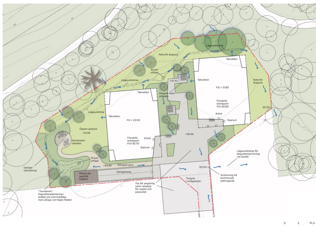
Figur 16. Principlösning för dagvattenhantering Rikshems kvartersmark. Erhållen från Rikshem 2021-10-13.
