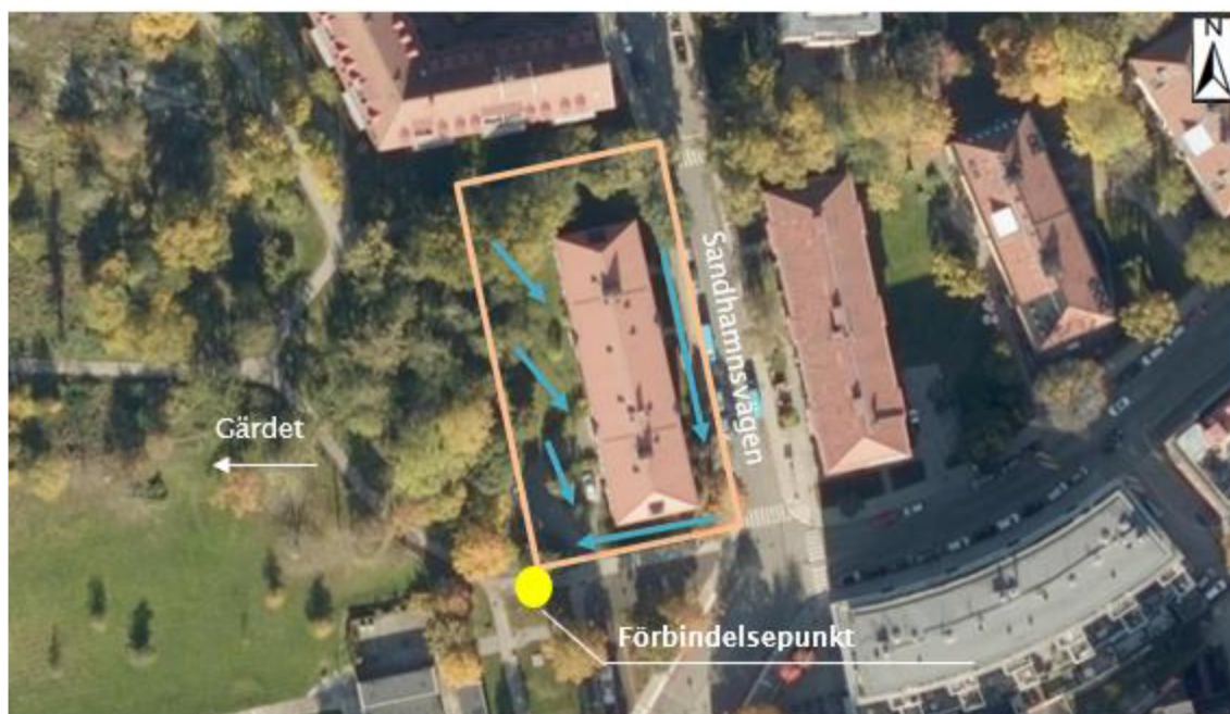
Figur 4. Utredningsområdet, generella ytliga rinnvägar (blåa pilar), och förbindelsepunkt till kommunalt avlopp. Flygfotot är hämtat från www.hitta.se ©Lantmäteriet.
