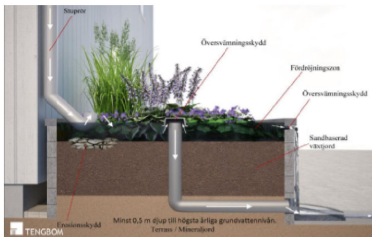
Figur 2. Bild på lösning kring ytlig fördröjning med upphöjda växtbäddar
