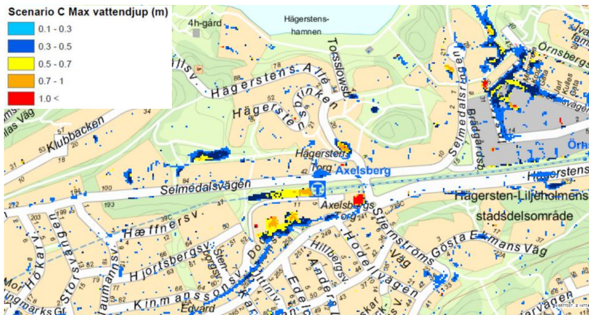
Figur 20. Skyfallsmodellering för ett 100-årsregn, vid befintlig situation för planområde Fader Bergström. Bilden visar maximalt vattendjup för marköversvämning (Stockholm Vattens skyfallsmodellering 2015).
