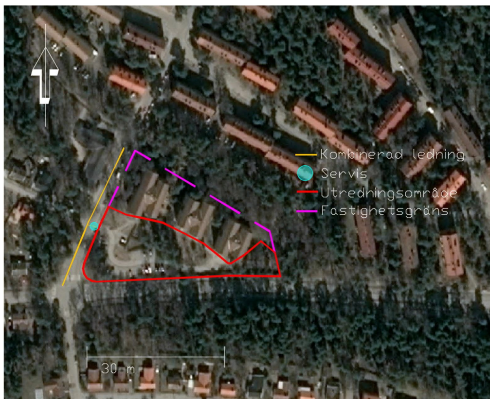
Figur 3. Servisanslutning vid fastighetsgräns som ansluter till kombinerad ledning med fall sydväst. Flygfotot ©2019MicrosoftCorporation ©2019DigitalGlobe.
