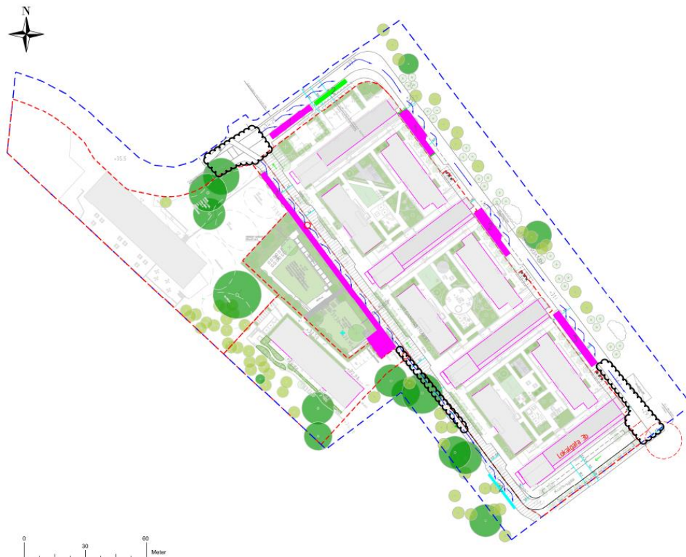
Figur 20. Översikt över ytor inom allmän platsmark som kan bli svåra att leda till en dagvattenanläggning. Dessa är markerade med svarta bubbelrutor. Skalan i figuren gäller ej.
