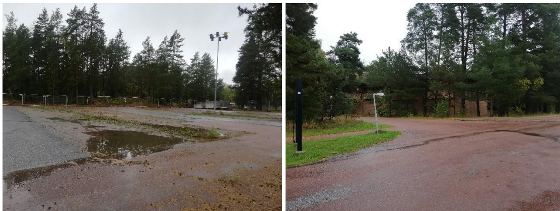
Figur 3. Till vänster: Befintlig parkering inom kv. Odde. Parkeringen består av asfalt och hårt packat grus och bedöms ha avrinningskoefficient 0,8. Till höger: Befintliga idrottshallen belägen vid Kista Allé väg.
