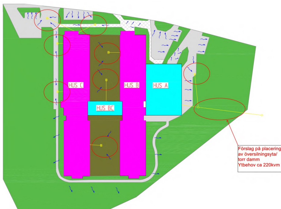
Figur 12 Skiss översikt LOD, förslag att nedsänka växtbäddar alt. Infiltration via grönytor anläggs i närhet till bef. brunnar (inringade på skiss), marklutning måste anpassas. I närhet av anslutningspunkt i öst är förslaget att anlägga överdämningsyta/torrdamm.
