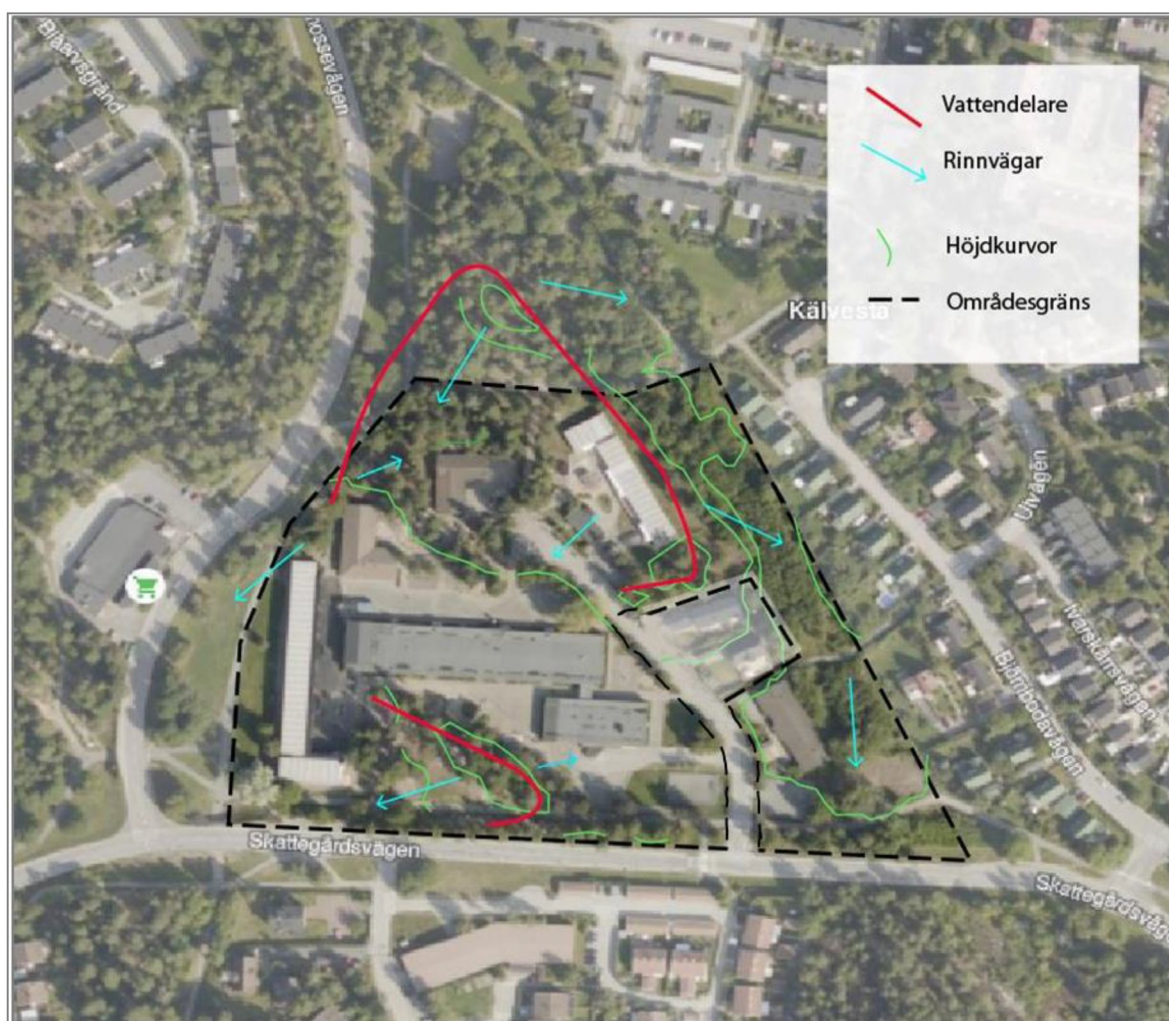
Figur 2 Vattendelare och avvattningsvägar inom området i befintlig utformning.
