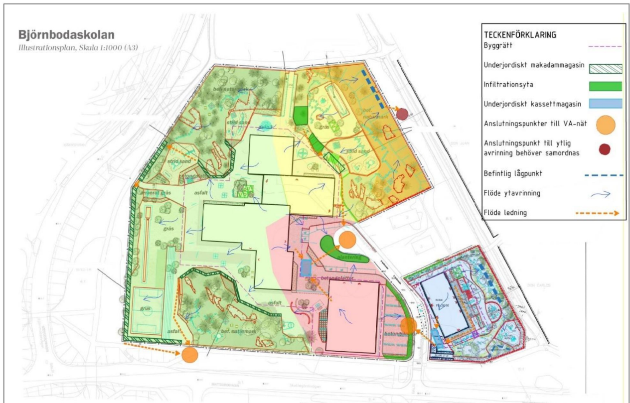
Figur 14 Illustration över föreslagen dagvattenhantering på platsen, områdesfördelning enligt figur 10.
