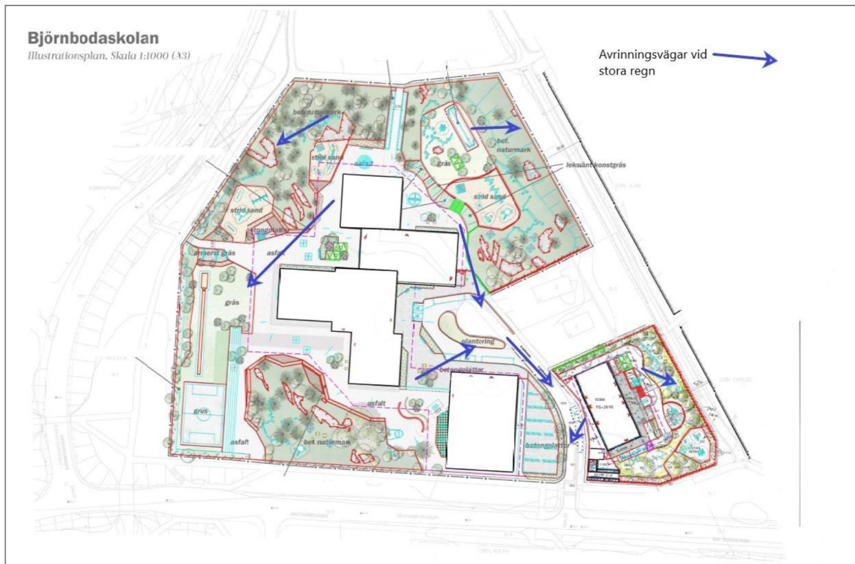
Figur 16 Avrinningsvägar vid stora regn som behöver tillgodoses genom höjdsättning
