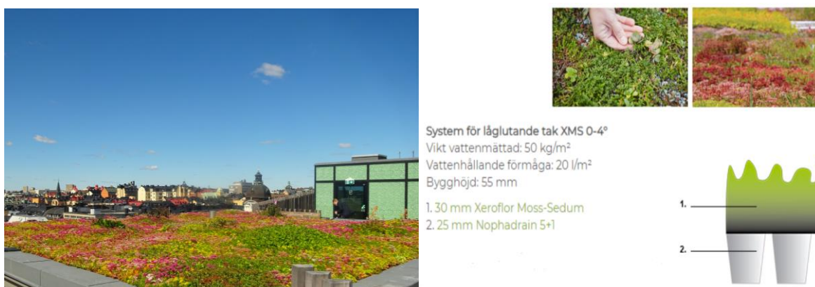
Figur 10. Sveavägen 44, grönt sedum-tak med pimpstensjord tjocklek 8–10 cm. (foto: Bara Mineraler) Samt möjlig uppbyggnad (illustration: Vegtech)
