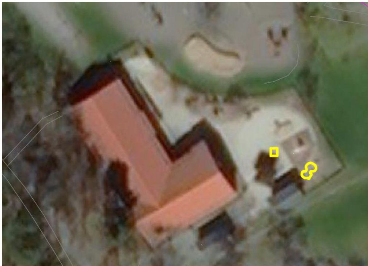
Figur 4 Identifierade problemområden på befintlig gård. Dagvattenbrunn är markerad med rektangel och området med pölbildning med en polygon (Bing, 2018).
