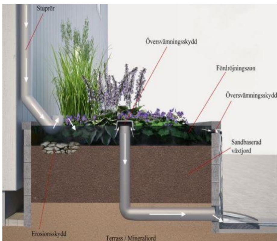
Figur 7. Principskiss över regnträdgård/växtbädd anslutning med stuprör.
