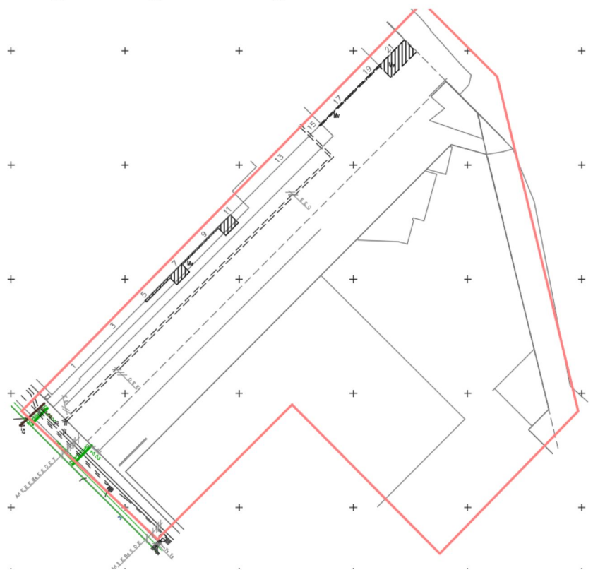
Figur 3 Dagvattenledningarna i bilden är markerade i grönt.
