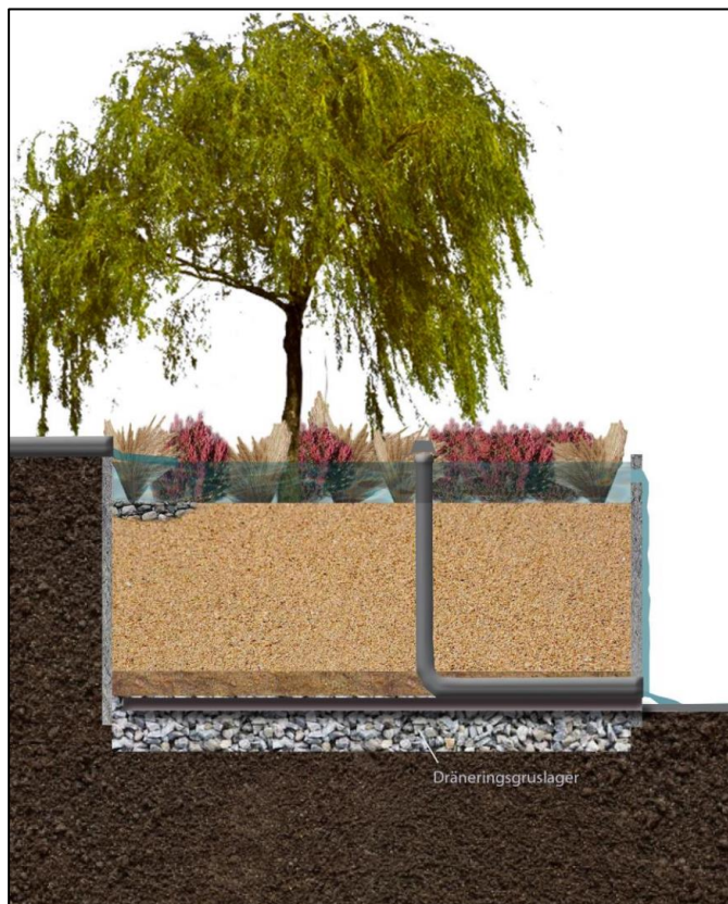
Figur 5-5. Exempelillustration av hur en regnbädd kan byggas upp (Illustration Åsa Wellander).
