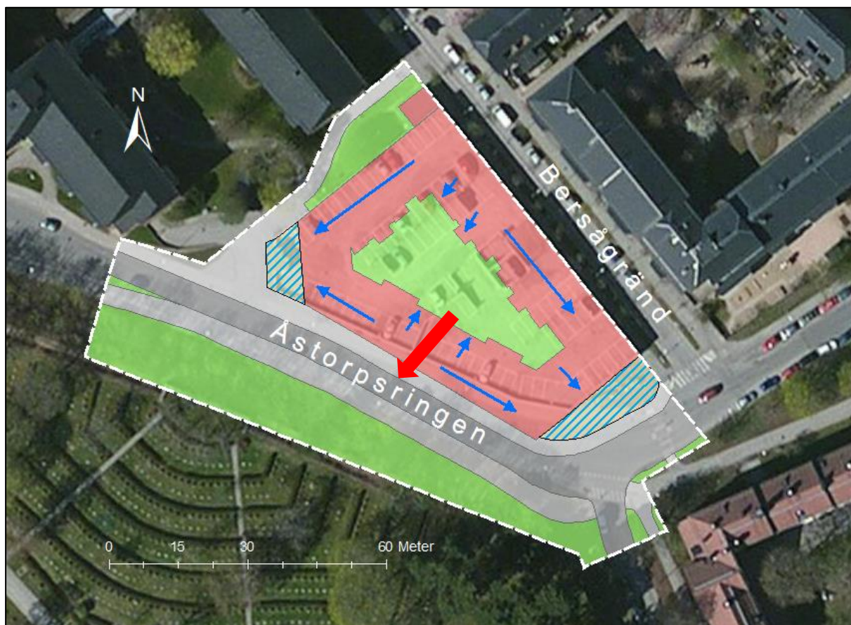
Figur 5-1. Principskiss med ungefärlig placering av makadammagasin (blåstreckad yta) under byggnadens entréytor. Röd pil visar ytlig avrinningsväg för dagvatten genom portiken vid extremregn.
