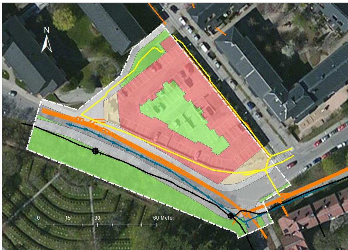
Figur 3-8. Ledningsdragningar inom- och i planområdets närhet. Gul linje = Ellevios nät, orange linje = Skanovas nät, svart linje = Stokabs nät, blå linje = gasledning tillhörande Gasnätet Stockholm.
