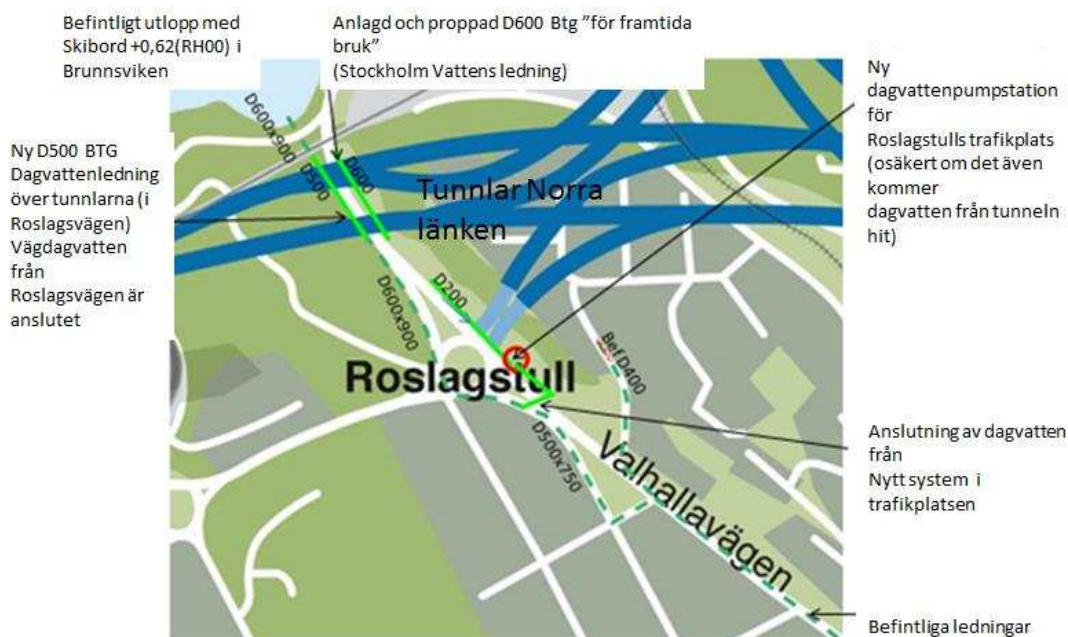
Figur 11: Schematisk skiss över befintliga ledningar (gröna streckade) och nyanlagda (ljusgrön heldragen) för avledning mot Brunnsviken.
