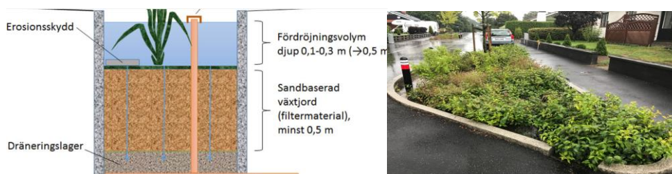
Figur 22. Principskiss för nedsänkt växtbädd till vänster (illustration WRS 16 ) och en nedsänkt växtbädd i gata med kantsläpp (Blomqvist, 2021 17 ).
