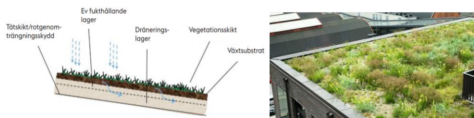
Figur 21. Principskiss för grönt tak i sektion till vänster och exempel på biotoptak till höger (Källor: WRS och VegTech 13,14 )
