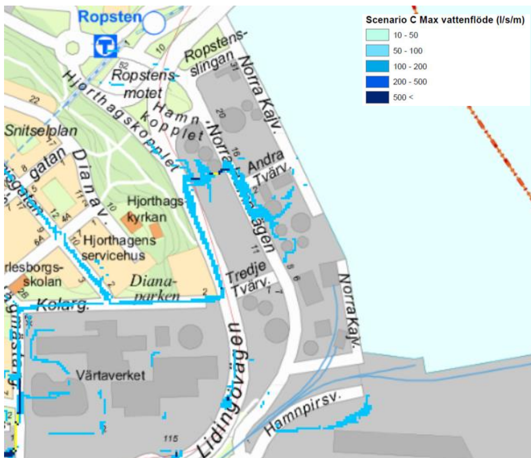
Figur 17 - Maximalt vattenflöde enligt Stockholms stads skyfallsmodellering, scenario C.
