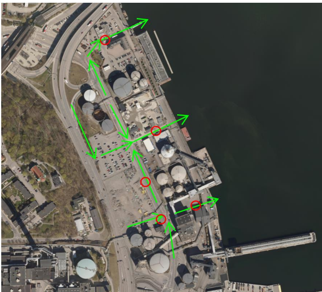
Figur 7 – Schematisk skiss över befintliga kommunala dagvattenledningar och förbindelsepunkter för dagvatten. Gröna pilar markerar ledningsbunden avrinningsriktning och röda cirklar kommunala förbindelsepunkter för dagvatten för de olika fastigheterna i området.
