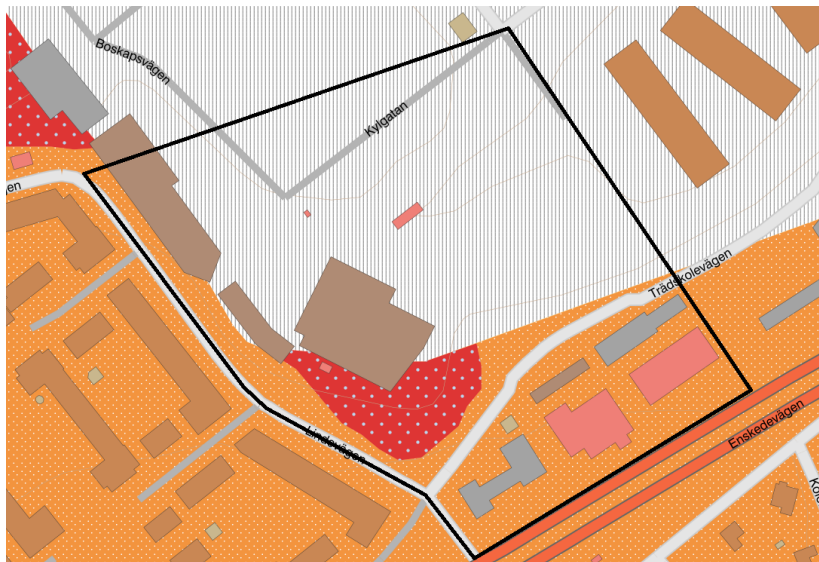
Figur 4. Planområdets geologiska förutsättningar från SGU:s jordartskarta. Grårandig yta är fyllning, röd yta med prickar är urberg med ett tunt eller osammanhängande lager av morän, orange är postglacial sand. Detaljplanens ungefärliga yta markerad med svart polygon.
