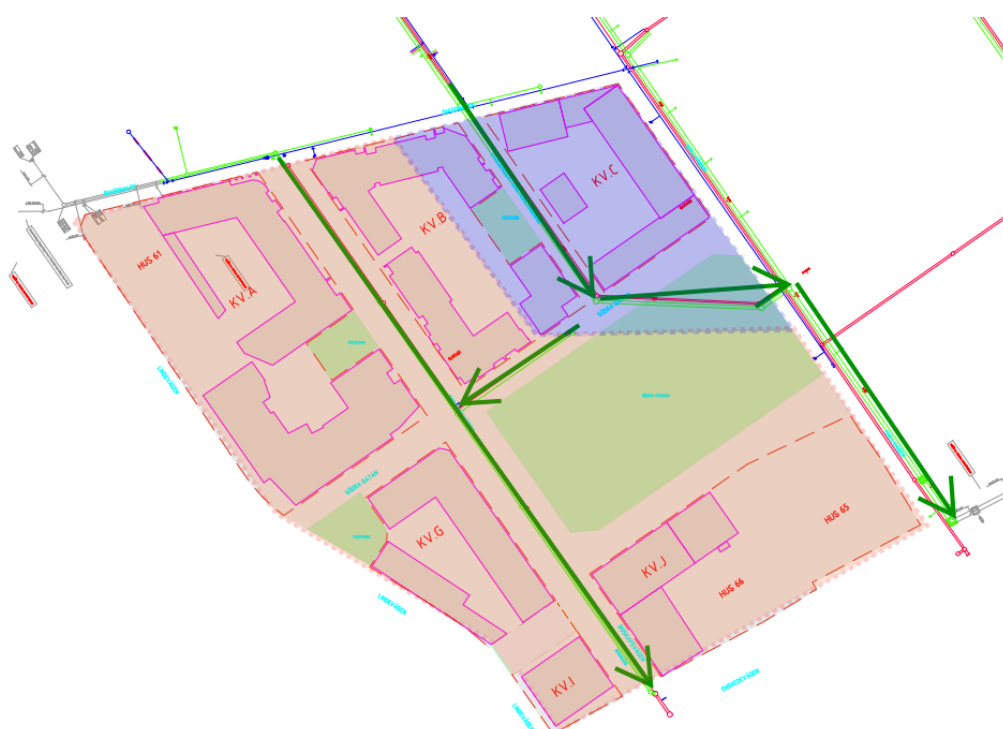
Figur 9. Ledningsnätets utformning i detaljplaneområdet. Gröna pilar visar nya dagvattenledningar. Orange delavrinningsområde kommer att koppla på det kombinerade ledningsnätet längre nedströms och vidare till Henriksdals ARV. Blått delavrinningsområde kommer att avvattnas till Östberga dagvattentunnel och vidare till Strömmen. Separeringen av det tidigare kombinerade delavrinningsområdet möjliggör för en framtida separering av systemet hela vägen till recipient.
