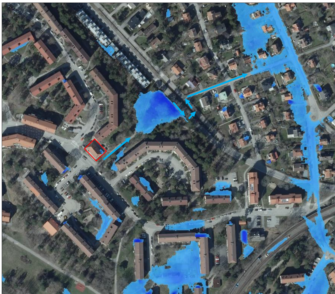
Figur 9. Lågpunkter där vatten ställer sig vid ett 100-årsregn, samt flödesvägar. Modelleringen tar inte hänsyn till infiltration (Scalgo Live).
