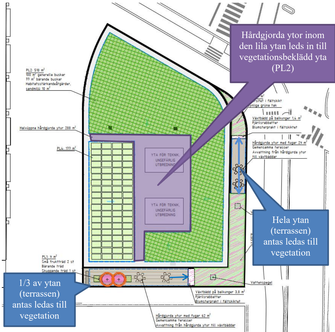
Figur 13. Utformning av takytorna inom kvartersmark. På alla två taknivåer planeras grönt tak. Den hårdgjorda ytan inom lila ruta leds in till de vegetationsbäddade ytorna.
