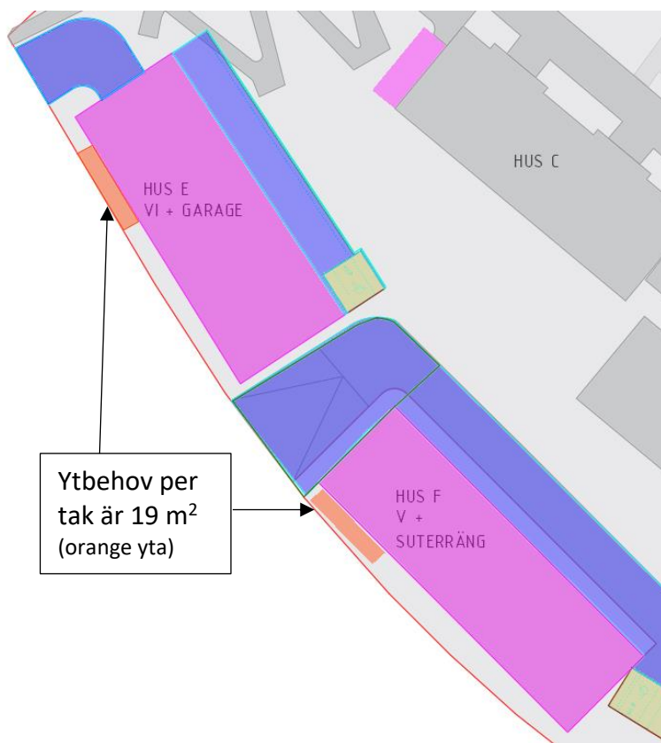
Figur 22. Ytbehov för regnbädd per tak är 19 \text{ m}^2 och har markerats i figuren (orange yta).
