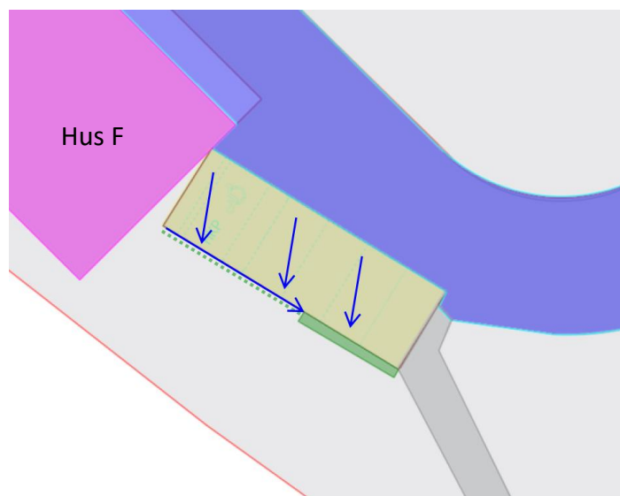
Figur 25. Föreslagen avvattning för avvattningsområde 4. Dagvattnet avleds ytligt till en nedsänkt regnbädd. Den utritade regnbädden i figuren är ca 3 \text{ m}^2 . Gröna streckade linjen är föreslagna öppna rännalsplattan, som leder vattnet vidare mot regnbädden.
