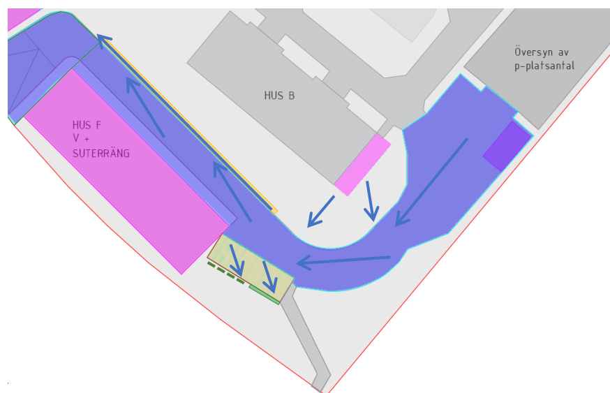
Figur 26. Föreslagen avvattning för avvattningsområde 6a och 8a samt kompensation för avvattningsområde 8. Gul polygon är utritad infiltrationsstråk och är ca 35 m 2 .
