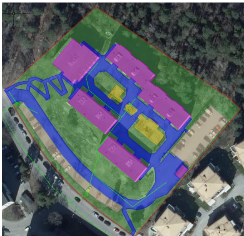
Figur 13. Ungefärlig placering av kvarterets befintliga ledningsnät (grön streckad linje), servispunkterna (grön ring) och det allmänna ledningsnätet (grön heldragen linje) i Aprikosgatan.
