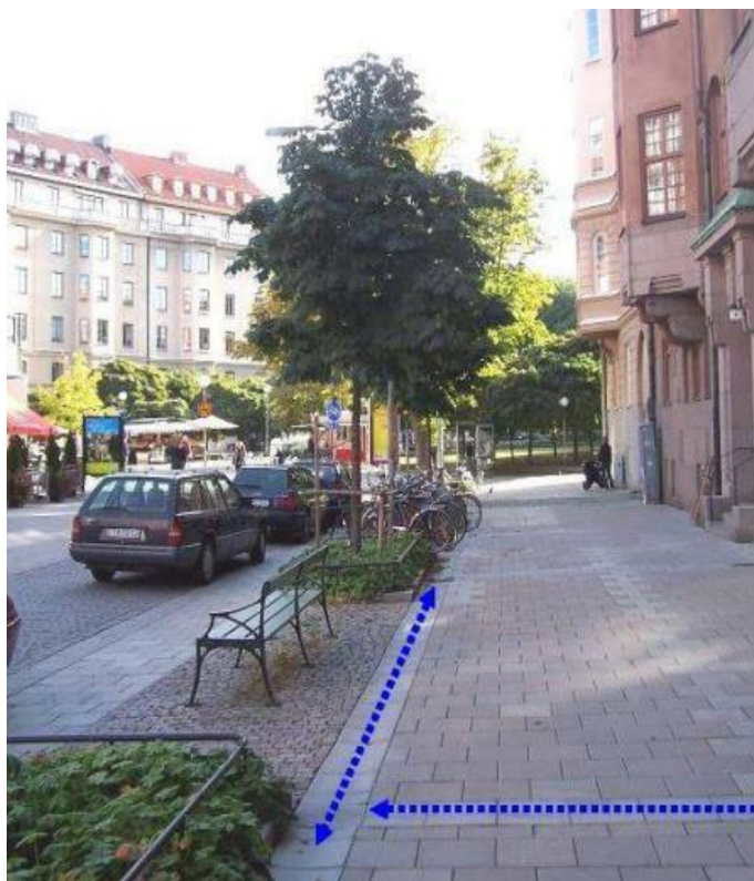
Figur 19. Exempelbild av hur takvatten kan avledas i rännalar till växtbäddar med en gemensam underliggande växt- och infiltrationsbädd (skelettjord) för träd (Foto av Örjan Stål och Björn Embrén).
