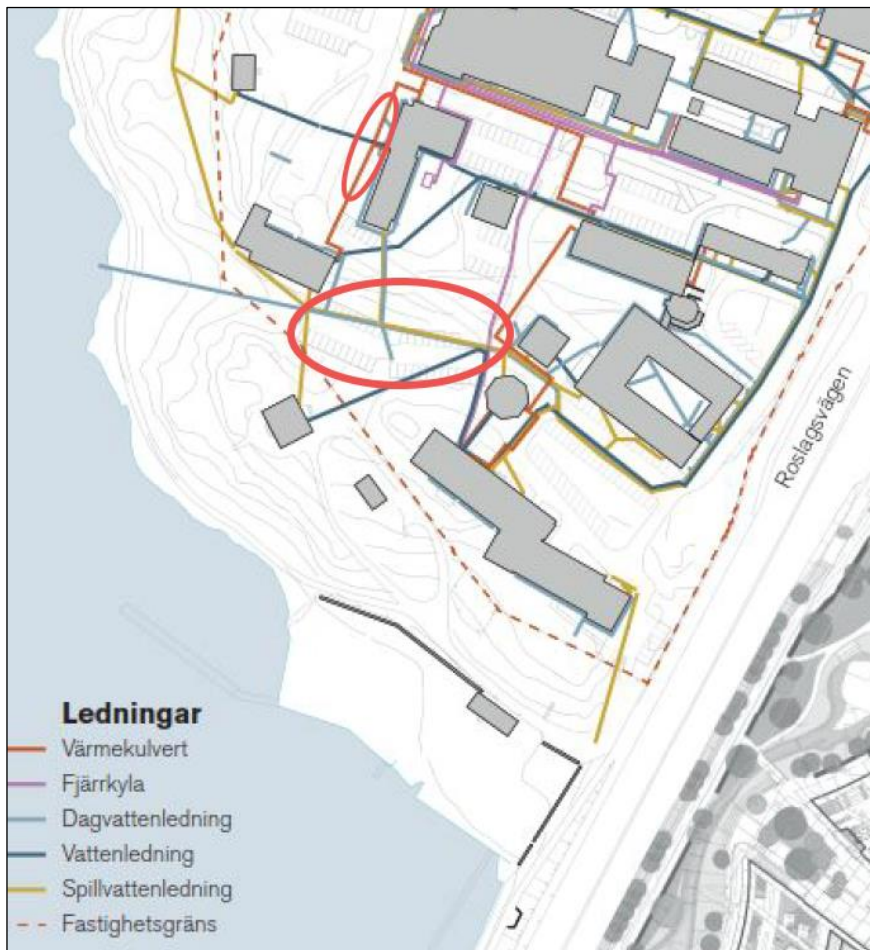
Figur 20. Tekniska ledningar inom planområdet. Röda cirklar markerar platser där framtida förslag på dagvattenhantering kan innebära konflikt med befintlig ledningsdragnings.
