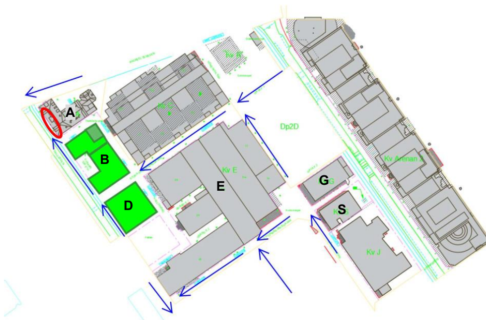
Figur 23. Sammanställning av dagvattenhantering inom kvarter B och D. Den mörkgröna linjen redovisar den underjordiska frisens sträckning. Inom Kvarter B finns en gårdsyta markerad med en grön polygon. Längs Kvarter A:s sydvästra sida finns ingen kvartersmark för avledning av vattnet från den rödmarkerade takytan. De ljusgröna ytorna markerar de kvarter som kan ledas till en dagvattenanläggning i enlighet med Stadens åtgärdsnivå. Pilarna visar översiktlig flödesriktning i planerat dagvattennät.
