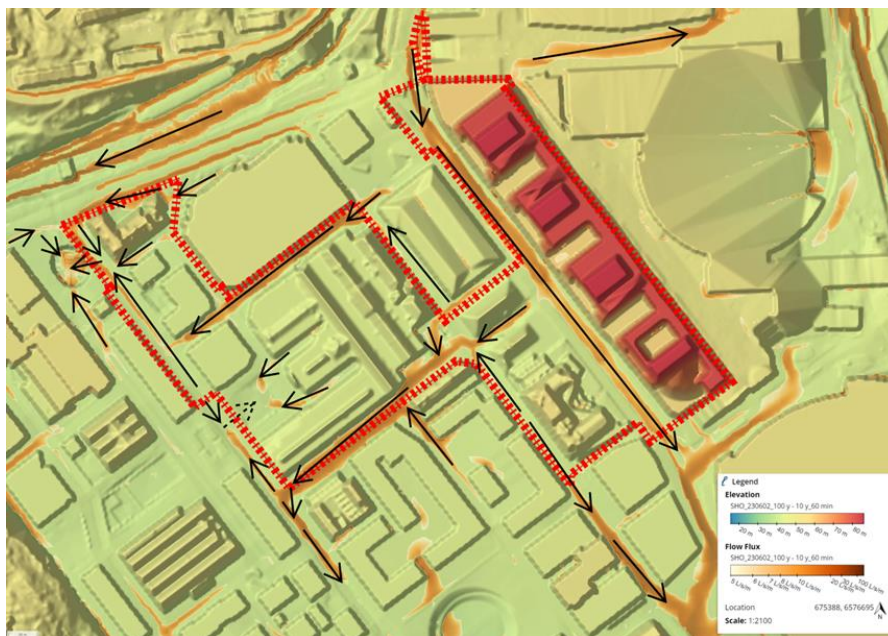
Figur 10. Avrinningsvägar vid framtida situation inom samt in och ut ur detaljplanegränsen för Dp 2a. Svarta pilar indikerar generell flödesriktning. Nyanser av orange indikerar olika storlekar på flödet, större flöden vid mörk nyans.
