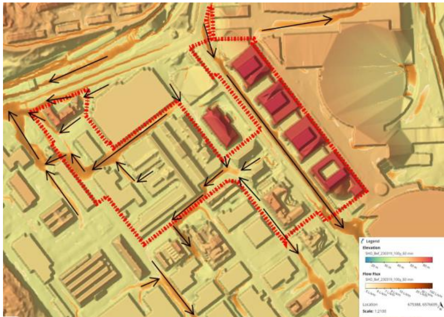
Figur 9. Avrinningsvägar vid befintlig situation in och ut ur detaljplanegränsen för Dp 2a. Svarta pilar indikerar generell flödesriktning. Nyanser av orange indikerar olika storlekar på flödet, större flöden vid mörk nyans.
