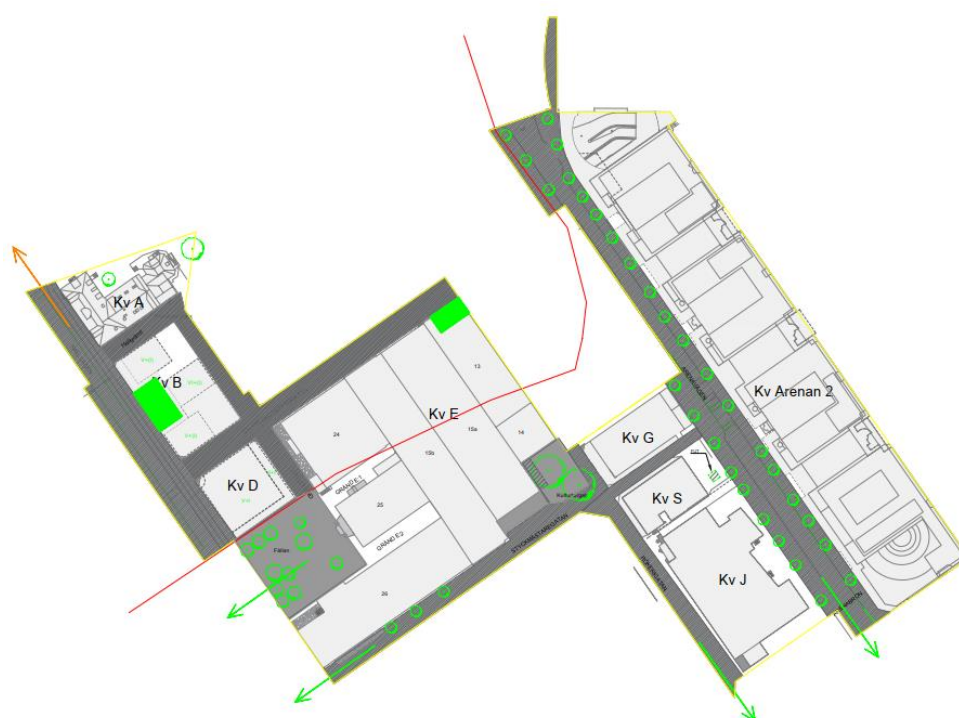
Figur 22. De två tekniska avrinningsområdena och utflödena från planen till Henriksdals avloppsreningsverk i Hallvägen (orange pil) och från Fällan, Styckmästaregatan, Rökerigatan och Arenavägen till Östberga dagvattentunnel nere vid Enskedevägen.
