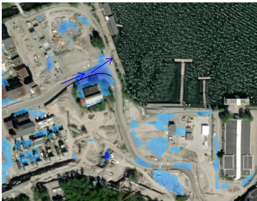
Figur 14. Lågpunktskartering från Scalgo Live. En större instängd lågpunkt är belägen vid Vattengasverket men avrinningsområdet dit är begränsat tack vare skyddande kantstenar längsmed Bobergsgatan (markerad svart linje).
