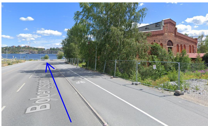
Figur 15. Kantsten längsmed Bobergsgatan skyddar Vattengasverkstomten från ytligt inkommande flöden (bild från Googles karttjänst).
