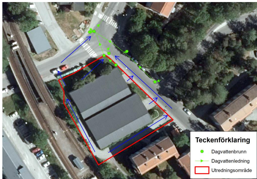
Figur 12. Teknisk avrinning (blåa pilar) inom och i angränsning till planområdet (röd markering) till duplicerade dagvattennätet samt brunnar.
