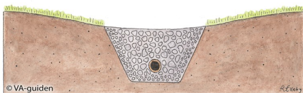
Figur 15. Principskiss makadamdike (t.v.) (källa: VA-guiden) och exempelbild på gräsbeklätt dike med dammen (t.h.).
