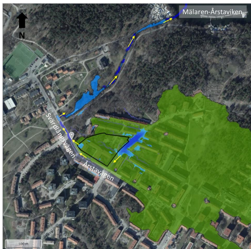
Figur 11-1. Befintlig avvattning från planområdet. Grön markering representerar tillrinningsområdet till det vatten som når Årstavägen och Svärdlångsvägen. Gula pilar illustrerar flödesriktningen. Recipient Mälaren-Årstaviken syns i nordöstra hörnet av figuren. Figur skapad i Scalgo Live (2022).
