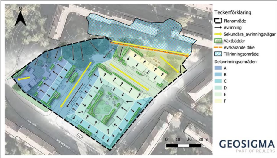
Figur 12-1. Principskiss på föreslagen dagvattenhantering, avrinning vid normala flöden samt sekundära avrinningsvägar för planområdet.
