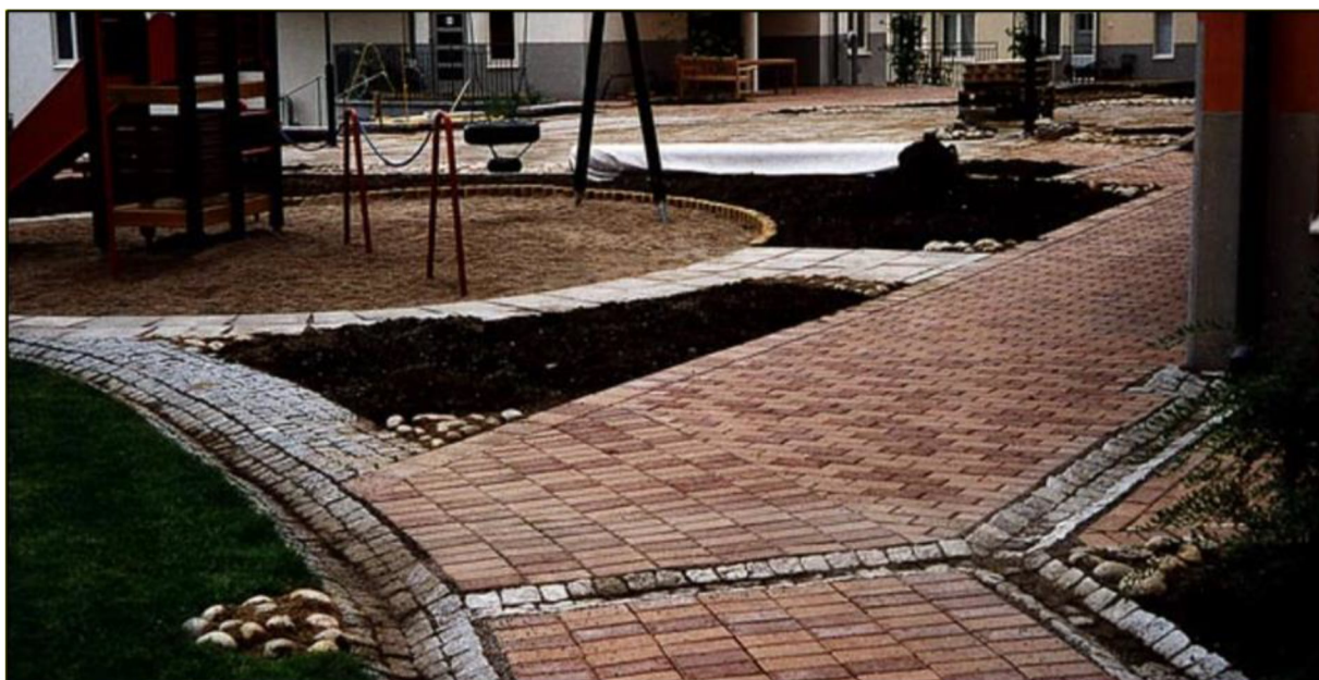
Figur 10-2. Exempel på avledning av takvatten via rännor anlagda med gatsten (Källa: Stockholm Vatten AB, n.d.).
