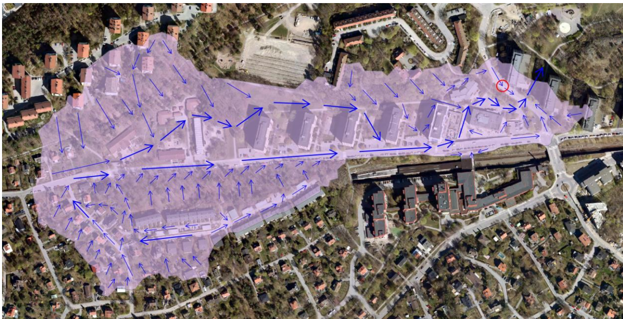
Figur 16. Avrinningsområde (lila markering) och ytliga avrinningsvägar (blå pilar) för dagvatten vid större skyfall. En lågpunkt i området bakom Axelsbergs centrum är markerad med röd ring. Notera att dagvattnet rinner vidare ut ur området i nordöst. Bilden är baserad på information från skyfallsmodelleringsverktyget Scalgo.
