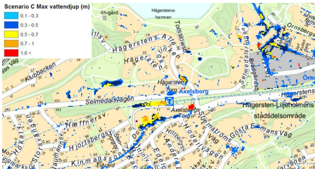
Figur 15. Skyfallsmodellering för ett 100-årsregn, vid befintlig situation för planområde Fader Bergström. Bilden visar maximalt vattendjup för marköversvämning (Stockholm Vattens skyfallsmodellering 2015).
