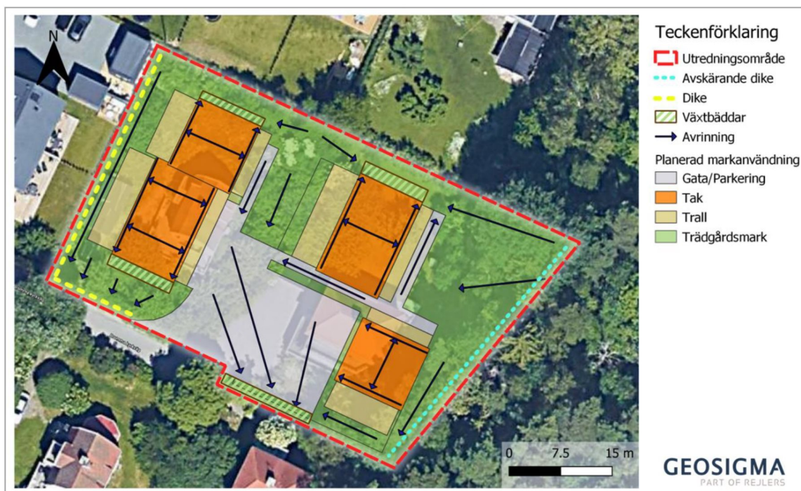
Figur 9-1. Översiktlig dagvattenlösning för utredningsområdet.
