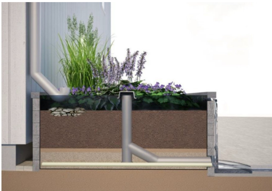
Figur 26. Principskiss på upphöjda växtbäddar (Bildkälla: Kent Fridell och Kristian Klasson, Tengbomgruppen AB.)
