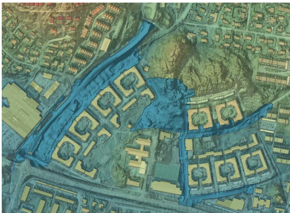
Figur 12 Höjdmodell som använts vid analys i Scalgo Live. Inom blå områden har nivåer från inmätning 2022 använts (Scior), för övriga områden används laserscannade data från lantmäteriet, 2023.
