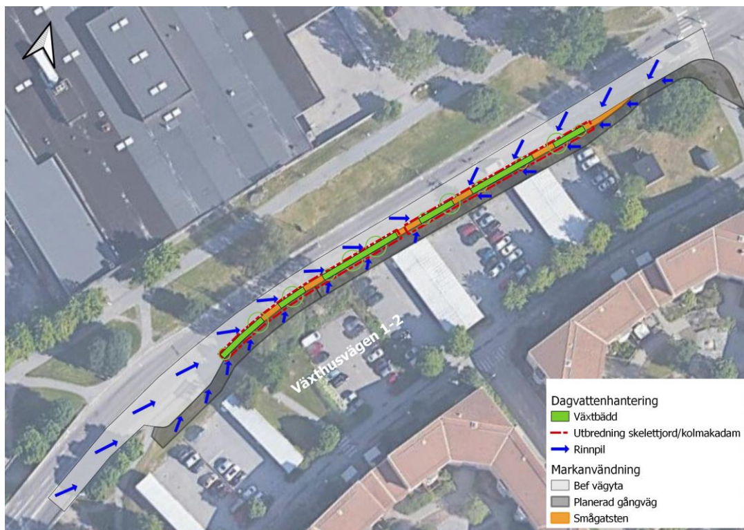
Figur 17 Föreslagen dagvattenhantering för södra delen av Växthusvägen (Växthusvägen 1-2). Baseras på arbetsmaterial till systemhandling, L-30-P-001, Tengbom, 2023-03-01.
