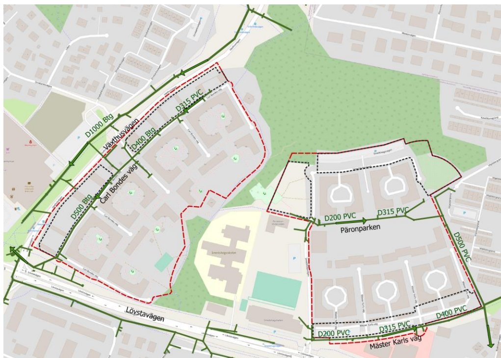
Figur 10 Befintligt dagvattenledningsnät i och i anslutning till planområdet (samlingskarta, 2022)
