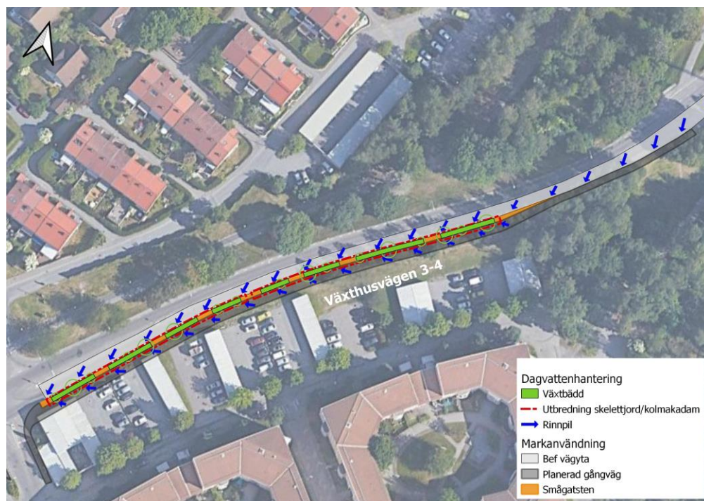
Figur 18 Föreslagen dagvattenhantering för norra delen av Växthusvägen (Växthusvägen 3-4). Baseras på arbetsmaterial till systemhandling, L-30-P-001, Tengbom, 2023-03-01.
